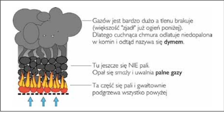
Rysunek 1 – Tzw. rozpalenie „od dołu”; źródło: www.czysteogrzewanie.pl
